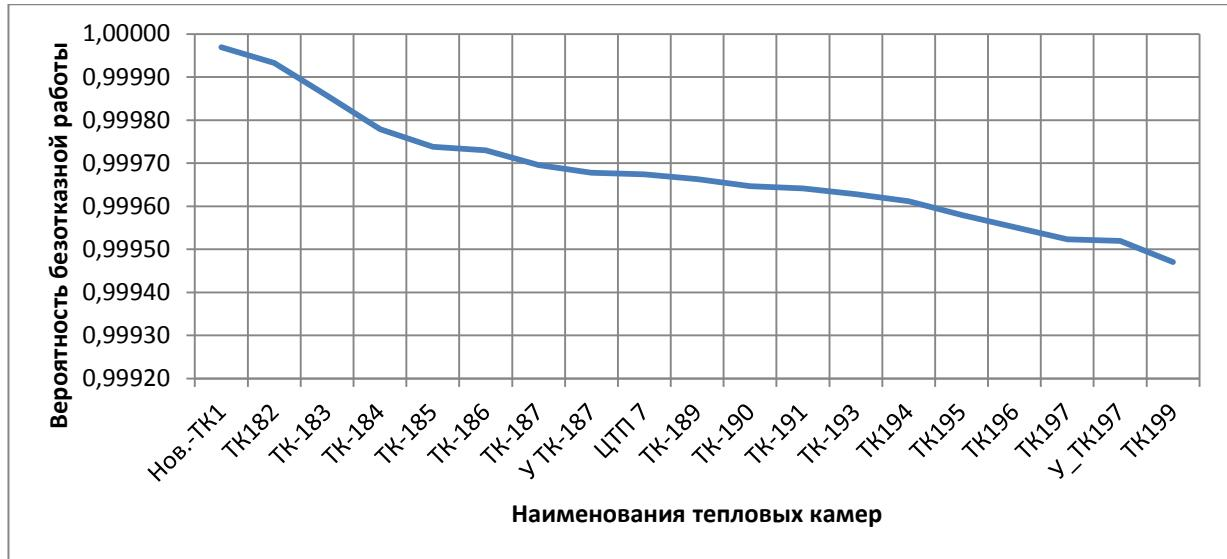
Рисунок 4.9 - ВБР относительно тепловых камер участка «Котельная №10 - ТК199» по состоянию на 2017 год
