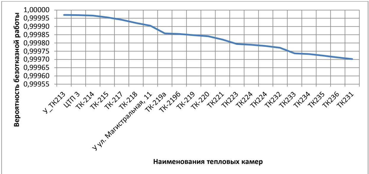
Рисунок 4.13 - ВБР относительно тепловых камер участка «ТК-213 - ТК231» по состоянию на 2017 год
