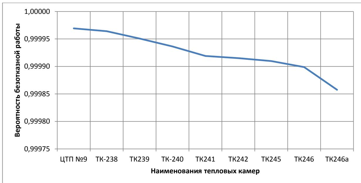
Рисунок 4.32 - ВБР относительно тепловых камер участка «TK-213 - TK246а» по состоянию на 2017 год
