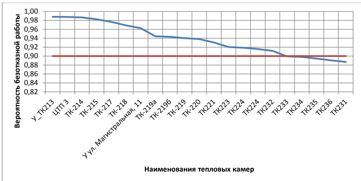
Рисунок 4.15 - ВБР относительно тепловых камер участка «ТК-213 - ТК231» по состоянию на 2027 год
