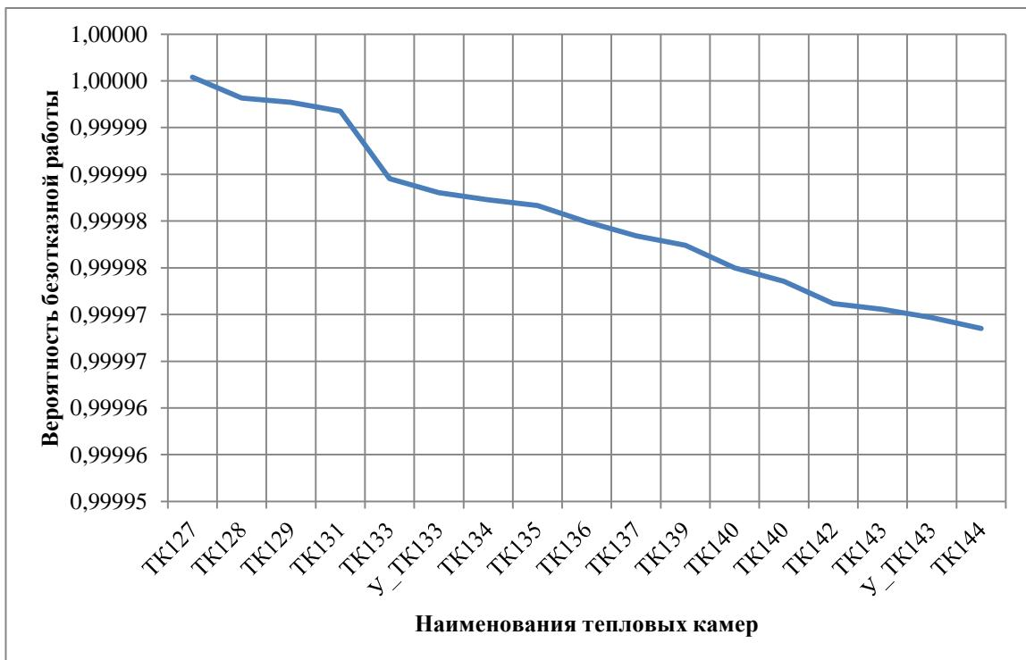
Рисунок 3.24 - ВБР относительно тепловых камер участка «TK55 - TK144» (в укрупненном масштабе)
