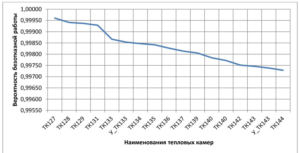
Рисунок 4.30 - ВБР относительно тепловых камер участка «TK55 - TK144» по состоянию на 2022 год
