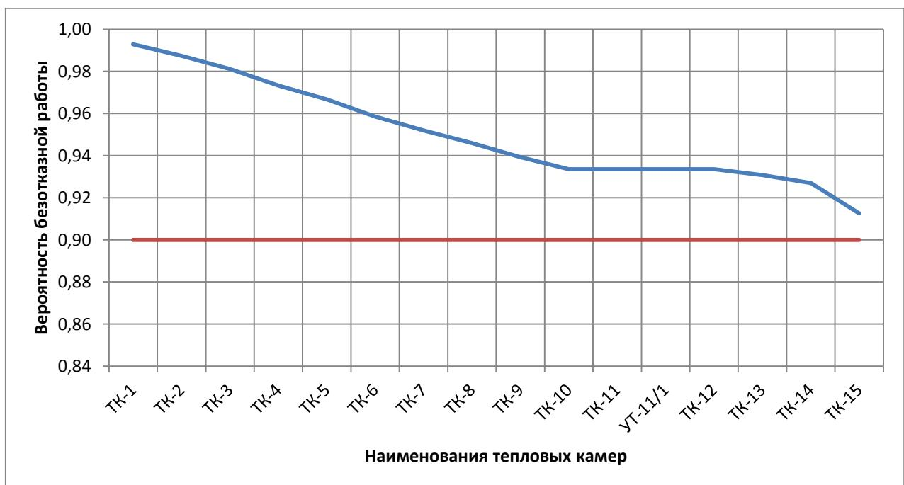
Рисунок 4.38 - ВБР относительно тепловых камер участка «БМК №2 - ТК-15» с учетом предлагаемых мероприятий по состоянию на 2027 год
