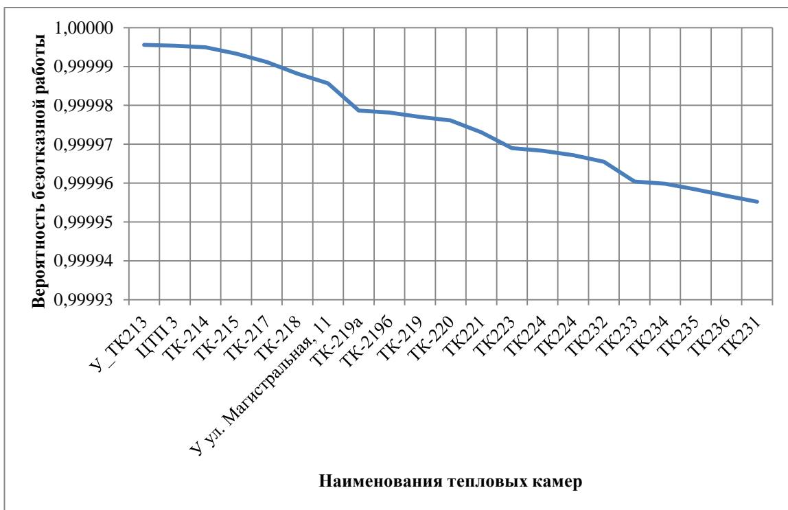
Рисунок 3.27 - ВБР относительно тепловых камер участка «TK-213 - TK231» (в укрупненном масштабе)
