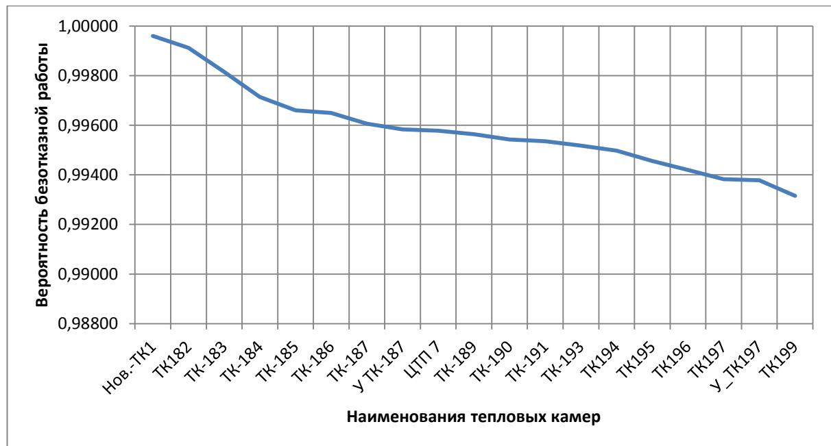
Рисунок 4.10 - ВБР относительно тепловых камер участка «Котельная №10 - ТК199» по состоянию на 2022 год
