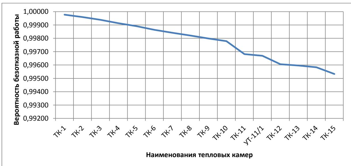
Рисунок 4.36 - ВБР относительно тепловых камер участка «БМК №2 - ТК-15» по состоянию на 2022 год
