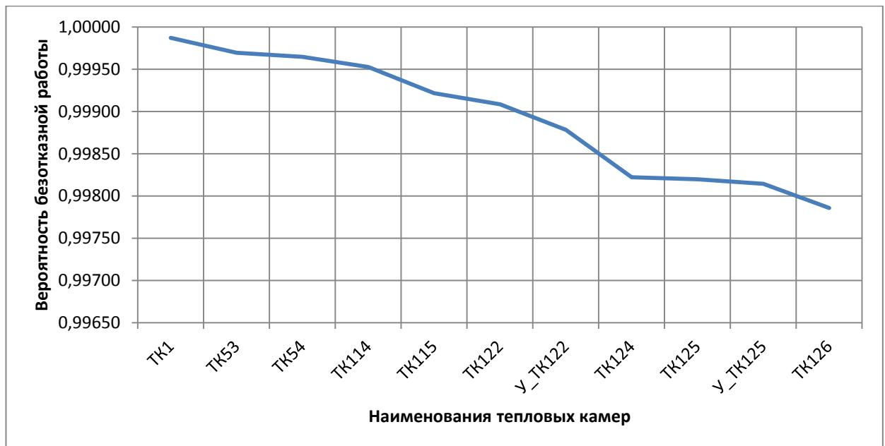
Рисунок 4.18 - ВБР относительно тепловых камер участка «Котельная №10 - TK126» по состоянию на 2022 год
