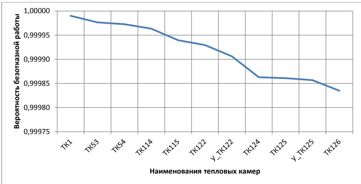
Рисунок 4.17 - ВБР относительно тепловых камер участка «Котельная №10 - TK126» по состоянию на 2017 год
