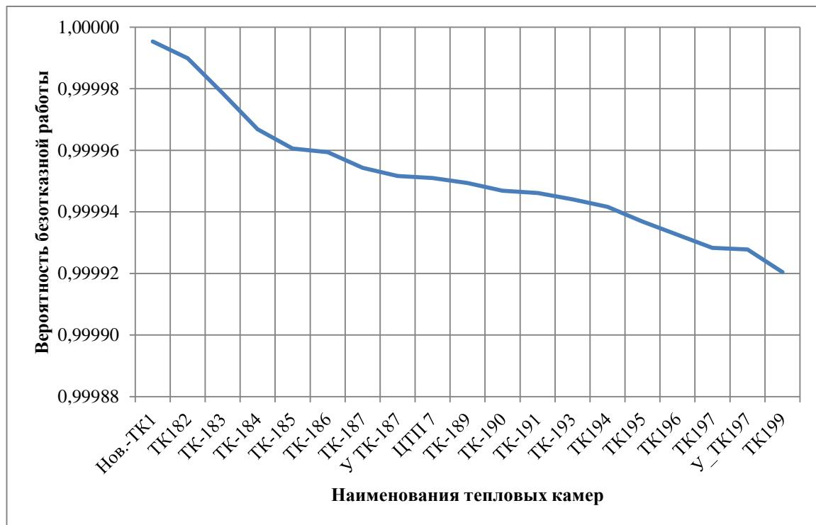
Рисунок 3.21 - ВБР относительно тепловых камер участка «Котельная №10 - TK199» (в укрупненном масштабе)
