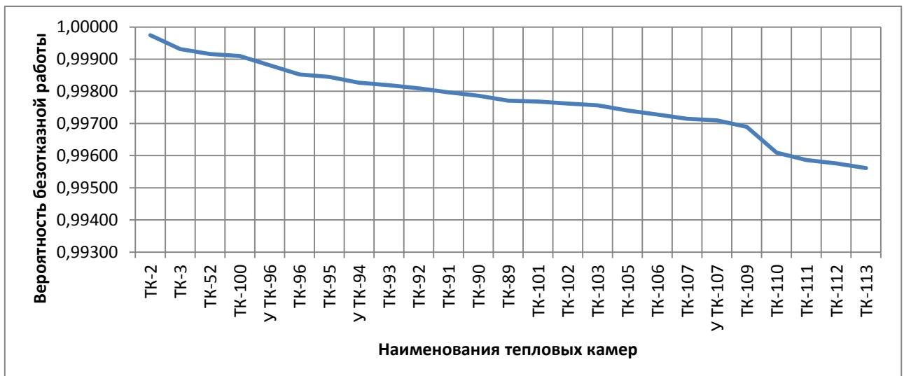
Рисунок 4.2 - ВБР относительно тепловых камер участка «TK1 - TK-113» по состоянию на 2022 год
