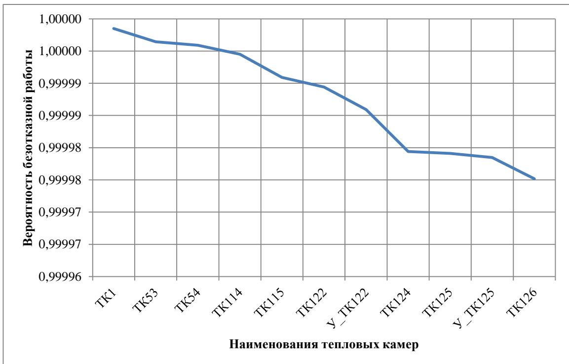
Рисунок 3.3 - ВБР относительно тепловых камер участка «Котельная №10 - TK126» (в укрупненном масштабе)
