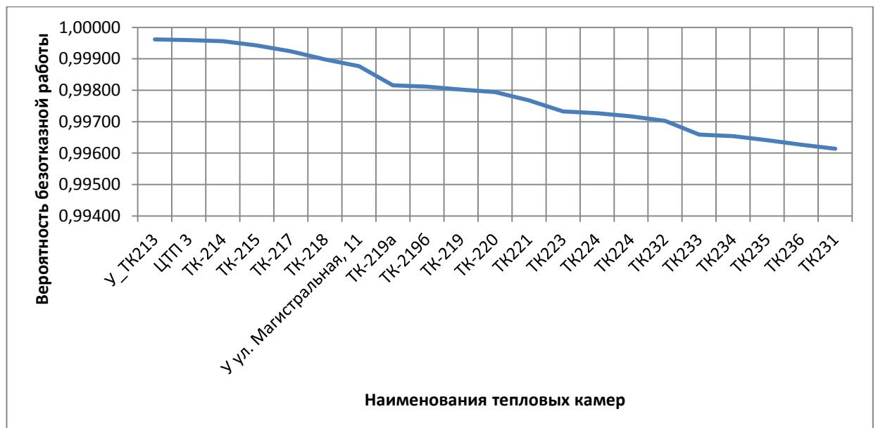
Рисунок 4.14 - ВБР относительно тепловых камер участка «ТК-213 - ТК231» по состоянию на 2022 год
