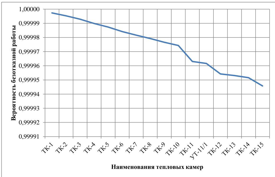
Рисунок 3.33 - ВБР относительно тепловых камер участка «БМК №2 - ТК-15» (в укрупненном масштабе)
