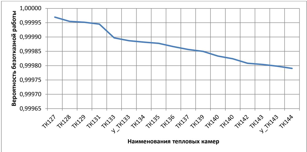
Рисунок 4.29 - ВБР относительно тепловых камер участка «TK55 - TK144» по состоянию на 2017 год
