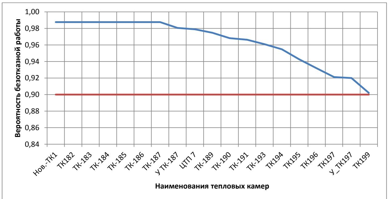
Рисунок 4.12 - ВБР относительно тепловых камер участка «Котельная №10 - ТК199» с учетом предлагаемых мероприятий по состоянию на 2027 год
