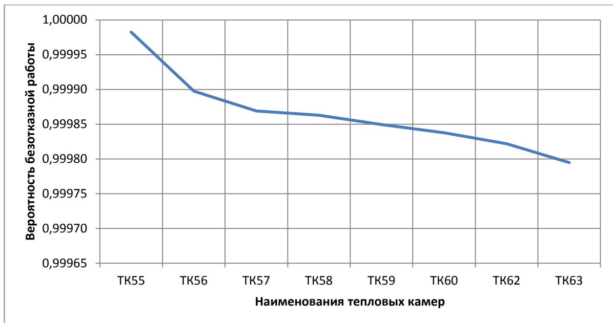
Рисунок 4.23 - ВБР относительно тепловых камер участка «TK54 - TK63» по состоянию на 2017 год
