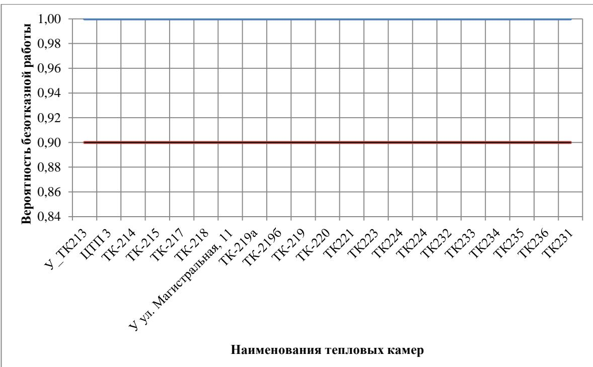
Рисунок 3.26 - ВБР относительно тепловых камер участка «TK-213 - TK231»
