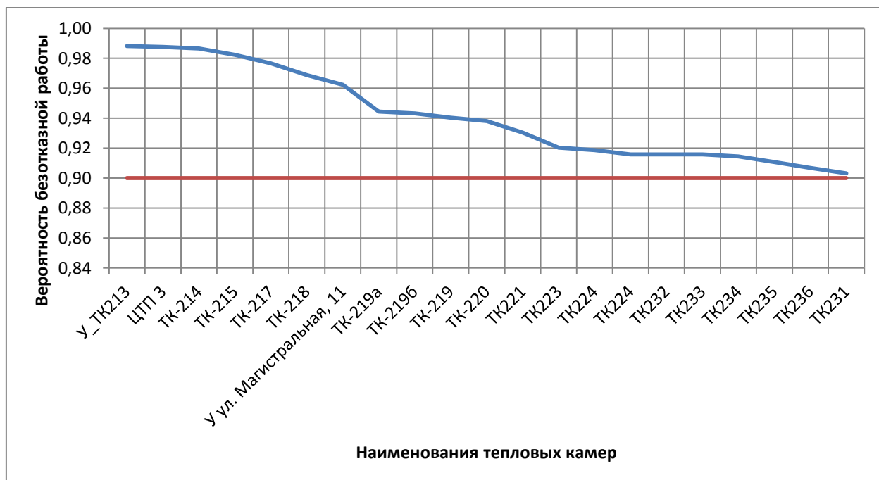
Рисунок 4.16 - ВБР относительно тепловых камер участка «ТК-213 - ТК231» с учетом предлагаемых мероприятий по состоянию на 2027 год
